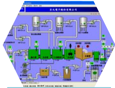
廢水處理監控系統
